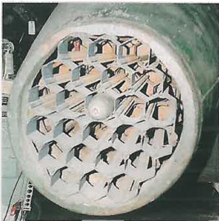
Jaktraketbatteriet i nosen.
